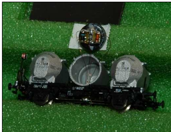
Bild 5.14: Montage der Konstantstromquelle Bild 5.15: Montage der Ladeschaltung
