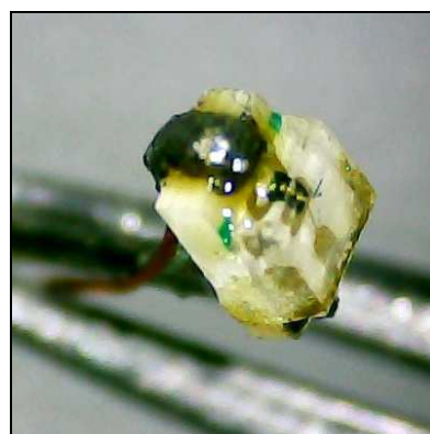
Bild 4.13: ChipLed mit montierten Anschlussdrähten
